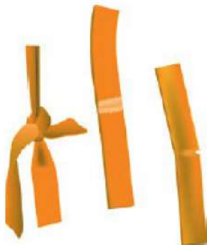
Figure 36 - Principaux défauts présents sur une sangle de levage
